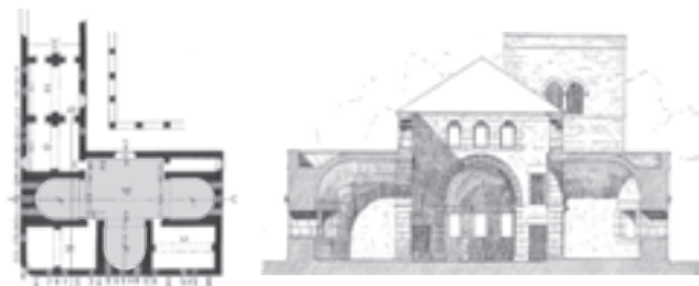
Fig. 6 - "Palais épiscopal". Plan et coupes Bosra (Province d'Arabie) D'ap. BUTLER 1914, fig. 248 et 253.
