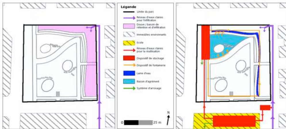
figure 4 : schéma des dispositifs techniques d'assainissement pluvial du parc Jacob Kaplan : à droite : le dispositif de stockage et de réutilisation (en dehors des périodes de gel) ; à gauche : le dispositif de rétention et d'infiltration
