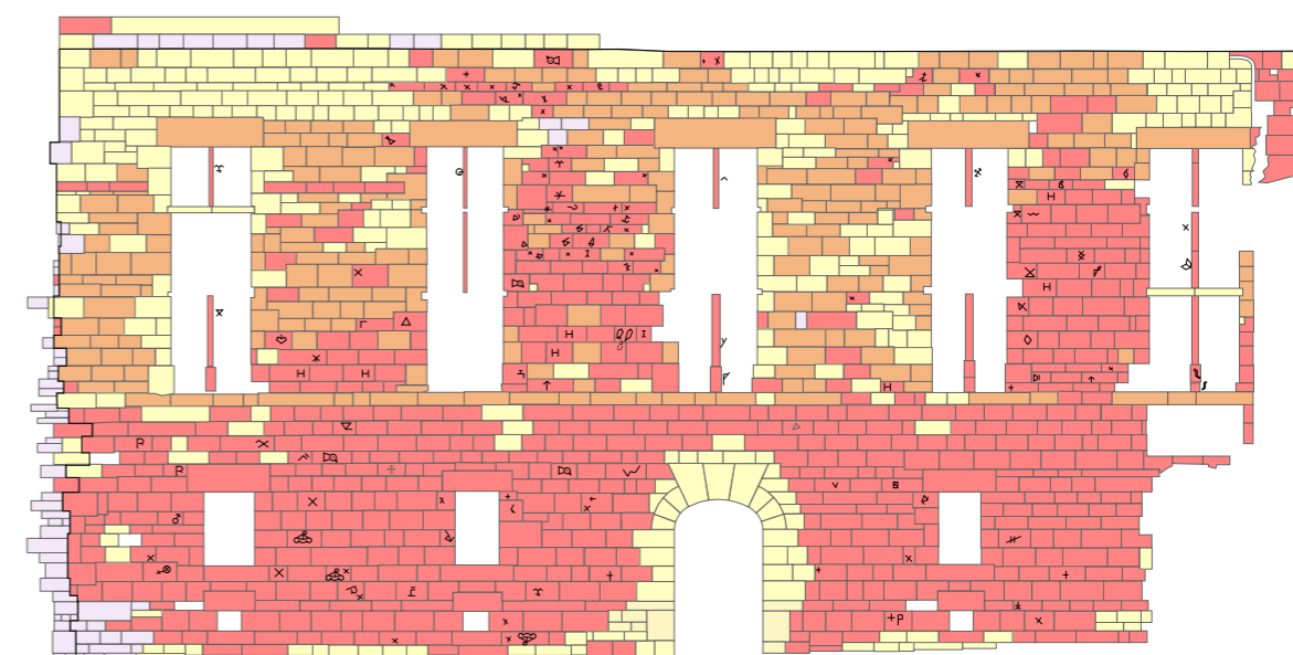
▼ Fig. 65 : façade nord : étude des marques de chantier et des réfections de maçonnerie. (La taille des marques a été augmentée ; relevés G. Auouy, Ph. Henrion, R.-P. Lehner ; dessin CeCaB mars 2012).
