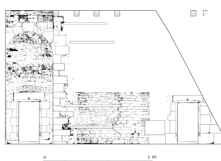
▲ Fig. 165 : 1 er étage de comble, chambre nord-ouest, parement ouest. À gauche la porte néogothique sous l'arc moderne devant le vestibule médiéval. À droite la porte vers la garde-robe. (Relevé et dessin Ph. Henrion).
