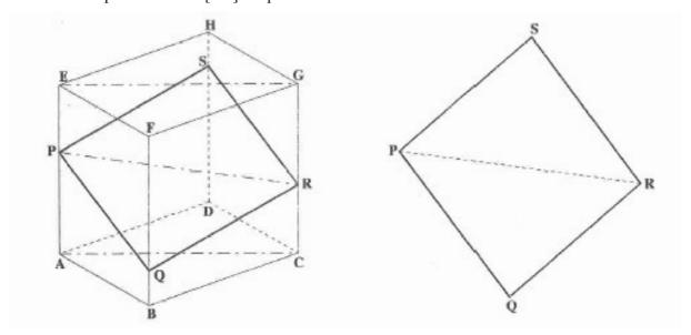
Perspective parallèle du dessin : projection sur un plan parallèle à un plan diagonal, les fuyantes font un angle de  $60^{\circ}$  et le coefficient de réduction est de 1/2.
