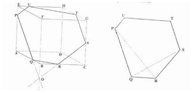
Perspective parallèle du dessin : projection sur un plan parallèle à une face, les fuyantes font un angle de 153° et le coefficient de réduction est de 3/5.
