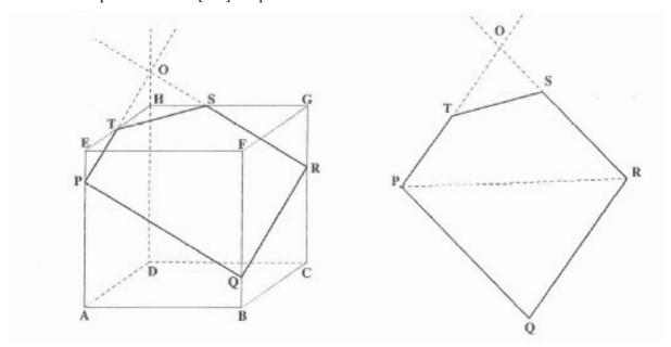
Perspective parallèle du dessin : projection sur un plan parallèle à une face, les fuyantes font un angle de 35° et le coefficient de réduction est de 1/2.
