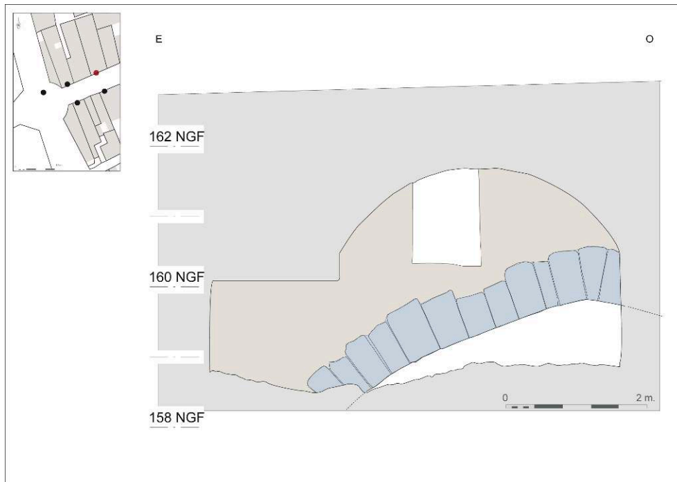
Figure 8. Relevé pierre à pierre de l'arche au fond de la cave côté rue, située au numéro 5 Rue du Pont. En bleu, l'unité de construction correspondant à l'arche
