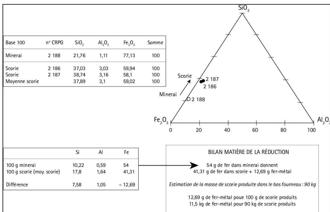
**Fig. 11** – Bilan matière simplifié de la réduction, établi à partir des résultats des analyses chimiques par spectrométrie d'émission réalisées sur le minerai et sur la scorie du fond du four (valeurs déduites des analyses chimiques présentées sur les figures 9 et 10).
