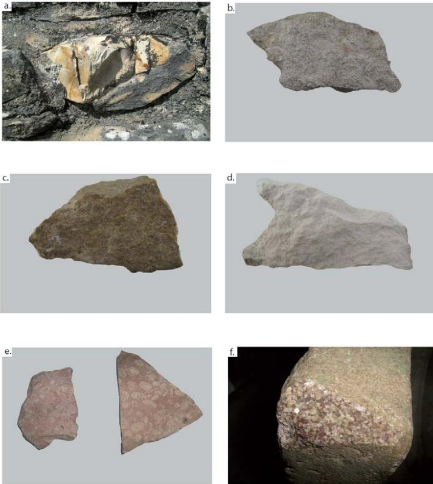
**Figure 5 :** a. Moellon de Calcaire rose de Premeaux (cliché : F. Delencre 2009) ; b. Fragment de moellon en Oolithe Blanche (cliché : F. Delencre 2009) ; c. Fragment de dalle de sol en Pierre de Ladoix (cliché : F. Delencre 2009) ; d. Fragment de fût de colonne en Pierre d'Asnières (cliché : F. Delencre 2009) ; e. Dalle de revêtement mural en Calcaire rouge de Givry (cliché : F. Delencre 2009) ; f. Niche en Calcaire à Entroques de Pouillenay (cliché : F. Delencre 2009).
