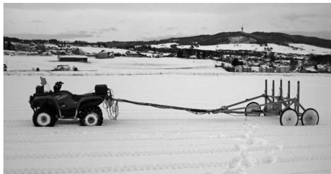
Fig. 1 – Quad équipé pour le relevé magnétique (cliché : Geocarta).
