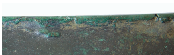
Fig. 6. Photo de détail montrant des irrégularités de fonte sur l'un des rebords (D. Stuart).
