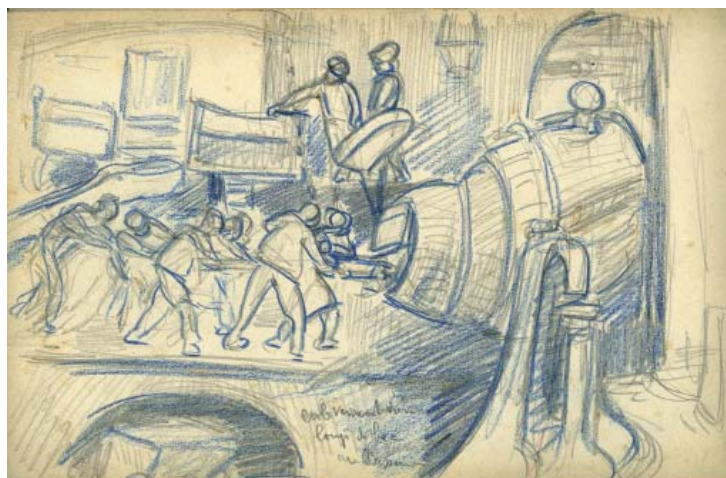
Dessin 58 : [Bessemer - Fabrication de l'acier Thomas : enlèvement d'un loup de bec au Bessemer] Mine de plomb et crayon de couleur bleu l. 26,5 x H. 17 cm Inscription de la main de l'artiste à la mine de plomb : « enlèvement d'un loup de bec au Bessemer ».
