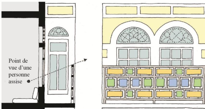
Figure 16. Du mur épais au balcon, le dédoublement de la façade (relevé et dessin de l'auteur).
