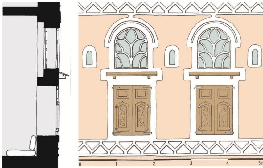
Façade et coupe d'une construction récente. Les murs ont une vingtaine de centimètres d'épaisseur. Le seuil de la porte qui ouvre sur le balcon est placé plus haut que le dossier de la banquette. Ainsi, cette porte ne dérange pas l'organisation de la pièce.
