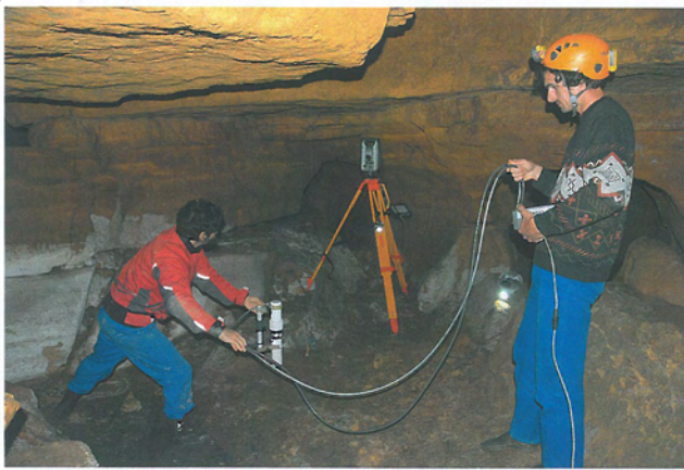
Figure 10 : Protocole de la prospection magnétique 3D utilisé à la grotte des Fraux. En 2011 (a) : les capteurs (cylindres blancs) sont déplacés manuellement par l'opérateur de manière à couvrir l'espace aussi bien que possible. Le prisme 360°, intercalé entre les deux capteurs, permet la géolocalisation des mesures par un système de poursuite du réflecteur par une station totale (présente en arrière-plan sur la photographie). En 2012 (b) : les capteurs sont suspendus au bout d'une perche télescopique fixée à l'aide d'une rotule articulée sur un trépied. Ce dispositif permet une couverture spatiale plus régulière. Protocol of 3D magnetic prospection in the cave of Les Fraux. a: in 2011, sensors (white cylinders) were moved by the hand of the operator. The 360° prism reflector (located between the both sensors) allowed us to obtain a geolocalization of the measurements by the tracking method of the total station (in the back of the picture). b: In 2012, a better control of the space covered was obtained thanks to a device made-up with a telescopic pole fixed on a tripod.
