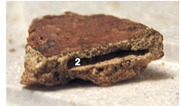
c. Ens. 10 479.106, tranche d'un fragment d'enduit bicouche comportant une forte proportion de tuileau dans la couche inférieure (1) ; encoche rectangulaire dans l'épaisseur de l'intonacco (2).
