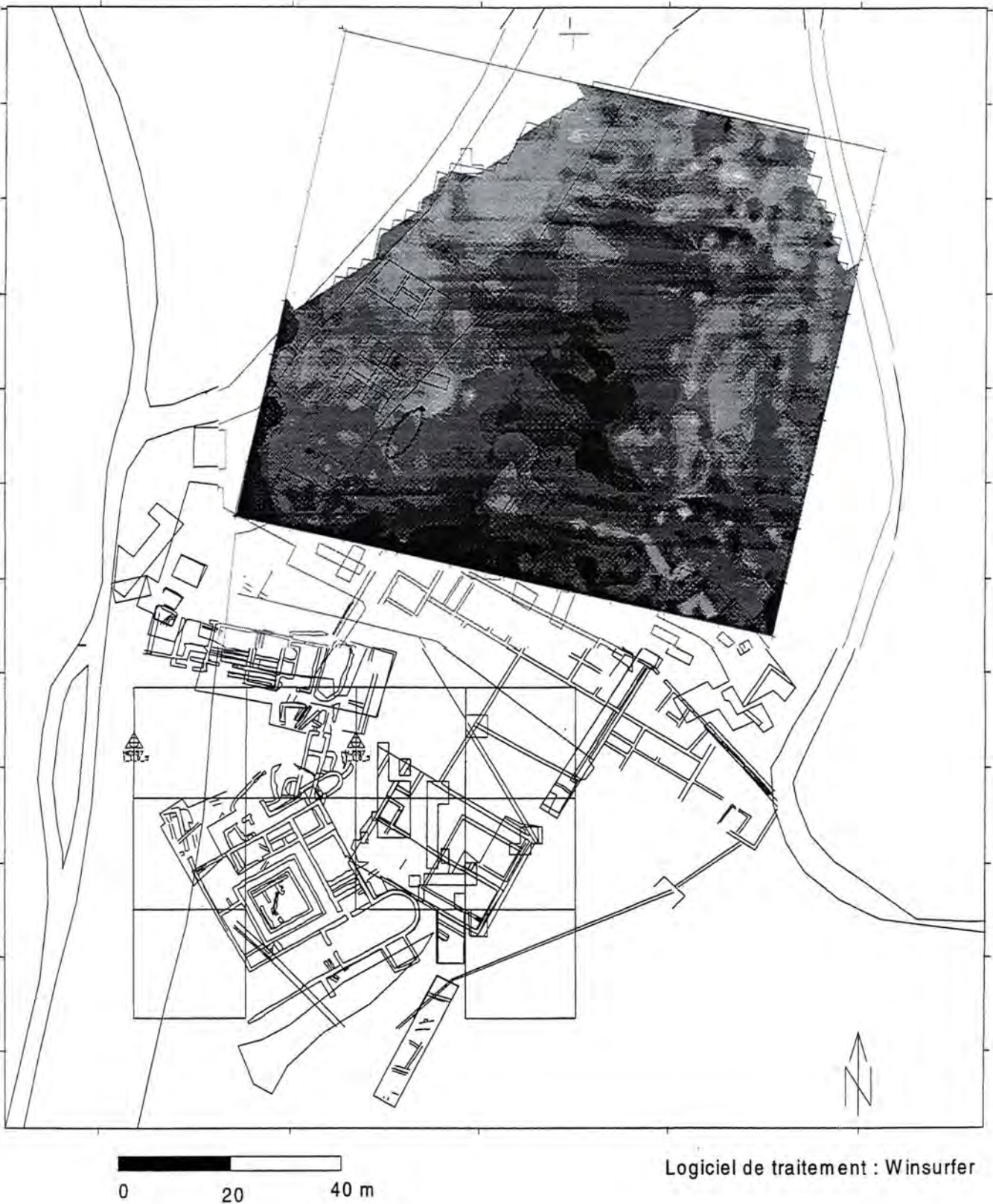
Fig. II.8.3 : Prospections géophysiques, exemple de superposition de données géophysiques et archéologiques, grâce à Surfer. Les données de prospection sont celles de la campagne de mesures électriques (DD) effectuée en 1985 sur la Pâturage du Couvent. (??)
