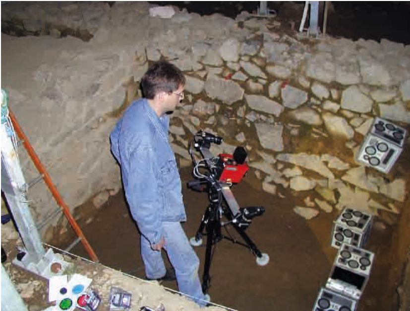
3. Recherches expérimentales sur l'enregistrement optique en 3D. Calibrage des cubes sur le terrain, avant les mesures les mesures enregistrées par la caméra. (Université de Munster, Allemagne).
