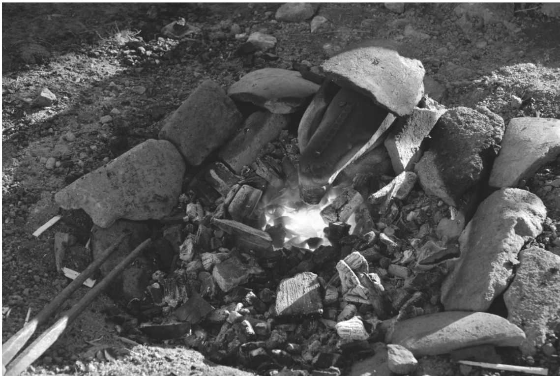
I 6. Bibracte, Mont Beuvray. Minière à la Pâtur des Grangerands. Tests expérimentaux à l'Echenault — le bas foyer avec sa tuyère coudée en cours d'opération. Le creuset est au centre du dispositif.
