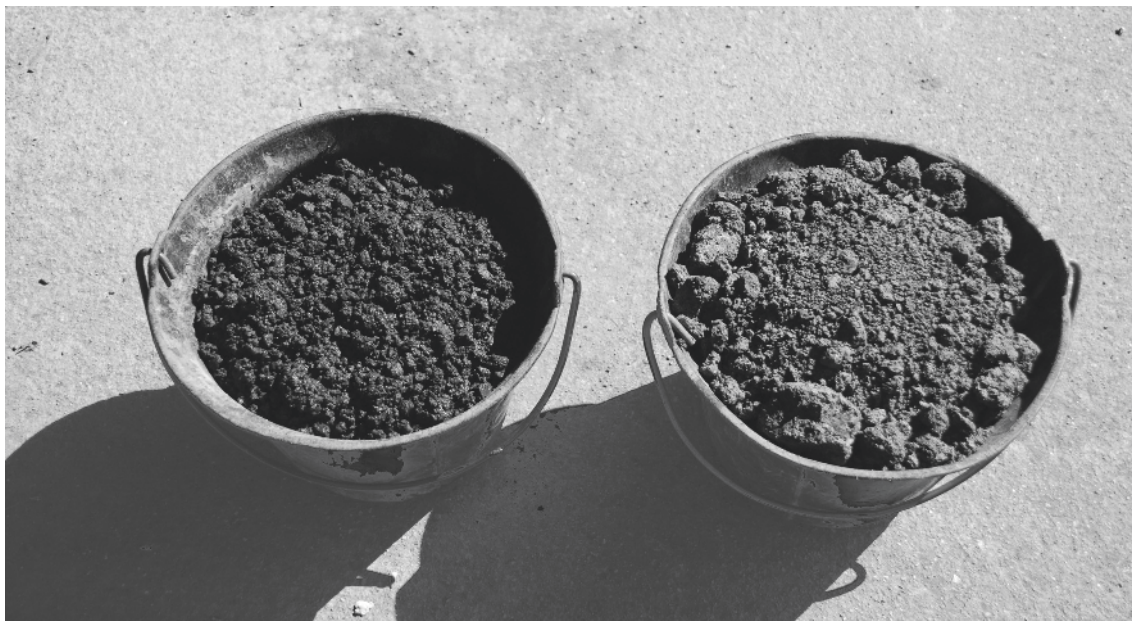
13. Bibracte, Mont Beuvray. Minière à la Pâturage des Grangerands. Tests expérimentaux à l'Echenault — à droite la rhyolite extraite du socle; à gauche la rhyolite après grillage.
