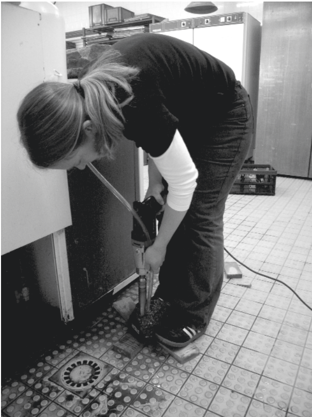
6. Bibracte, Mont Beuvra. Forage à la perceuse pour prélever l'échantillon (cliché L. Jaccotey).
