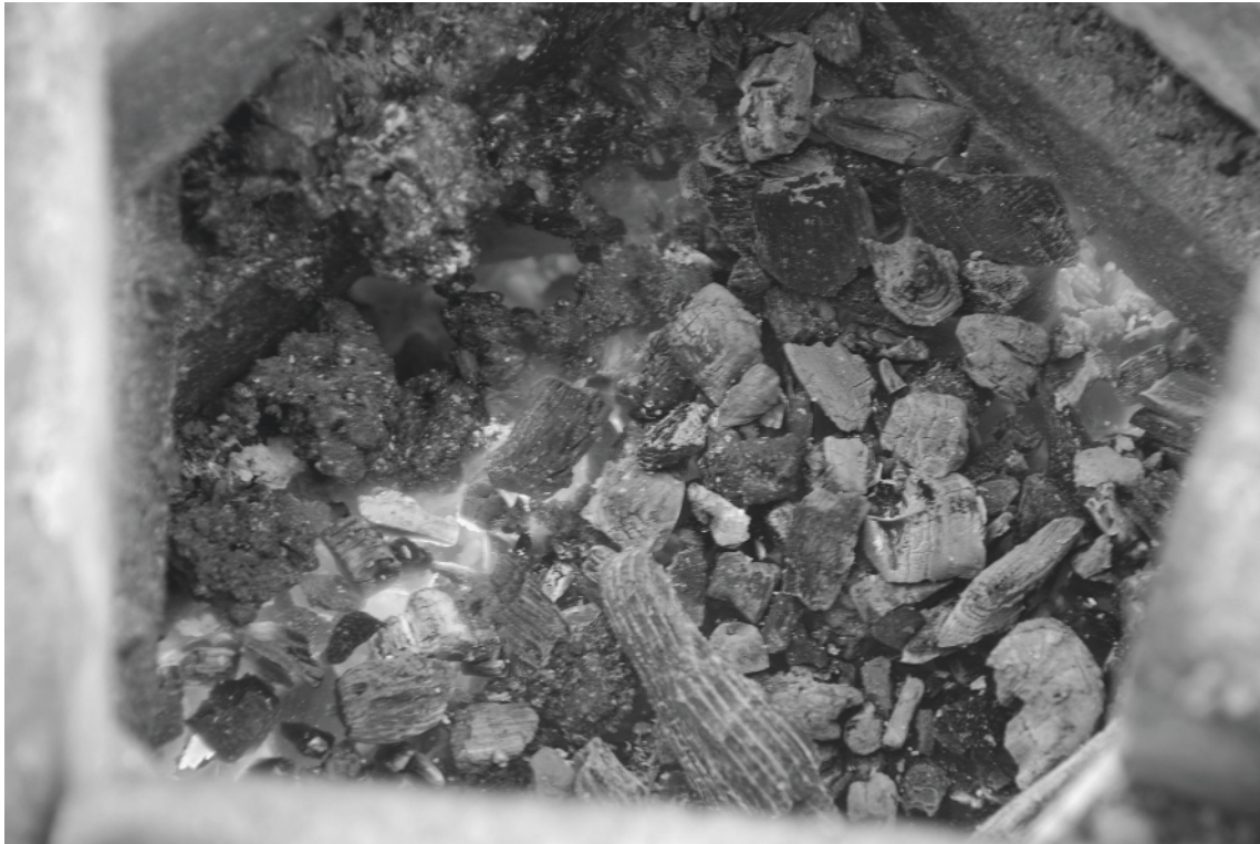
I 5. Bibracte, Mont Beuvray. Minière à la Pâtur des Grangerands. Tests expérimentaux à l'Echenault — vue à l'intérieur du fourneau de réduction en fin d'opération; en haut et à gauche la masse scoriacée.
