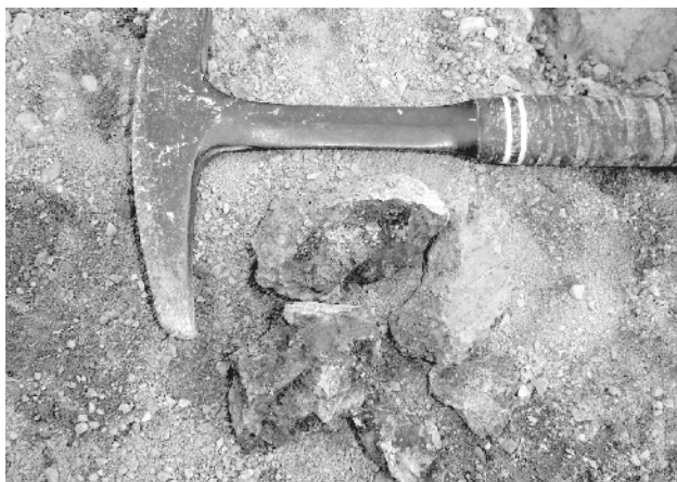
9. Bibracte, Mont Beuvray. Minière à la Pâturage des Grangerands. Fragments de minerai sulfureux oxydé intégralement et transformé en une masse d'oxy/hydroxydes de fer constituant le chapeau de fer.
