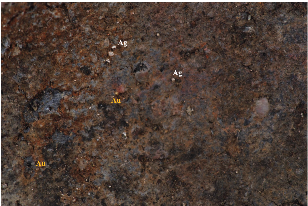
13. Bibracte, Mont Beuvray, La Pâturage des Grangerands. Deux fragments d'un même creuset d'orfèvre (B210.39.536.1). Ils proviennent du fond de l'Excavation 1, la plus ancienne, et donc du premier niveau de comblement. Grossissement de la paroi interne du fragment le plus important: on y voit des billes d'or et des billes d'argent. (Cliché B. Cauuet).
