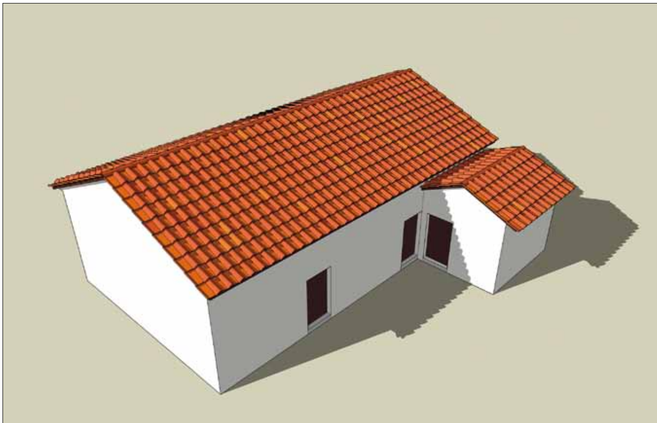
80 Hypothèse de restitution du bâtiment PS 0. Le corps principal de l'édifice était certainement couvert par un toit en bâtière unitaire. La toiture du petit local C, quant elle, a pu adopter différentes configurations (cf. supra, ill. 71). (Modèles 3D IASA/D. Glauser).
