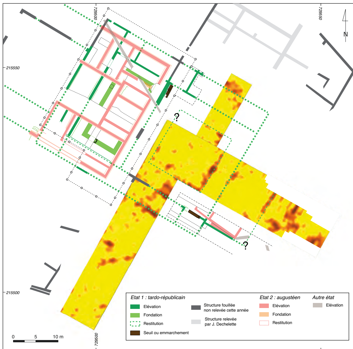
I 3. Bibracte, Mont Beuvray. Compléments d'observation à la Pâturage du Couvent. Interprétation des données géophysiques (géoradar, constante de temps 58 ns) effectuées au printemps 2013 (Z. Czajlik) par rapport aux structures relevées de l'état 1.
