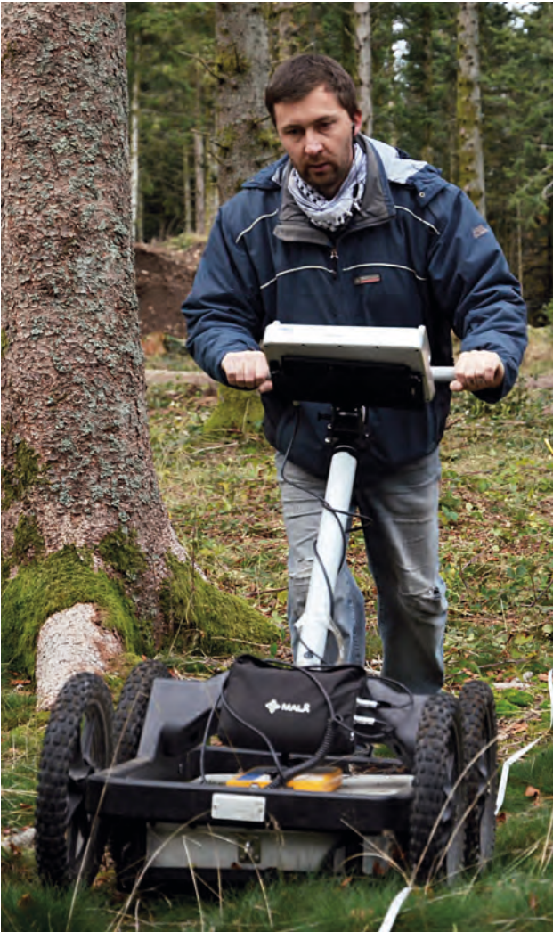
3. Bibracte, Mont Beuvray. Prospections géophysiques. Géoradar RAMAC X3M (marque Geoscience Malå).
