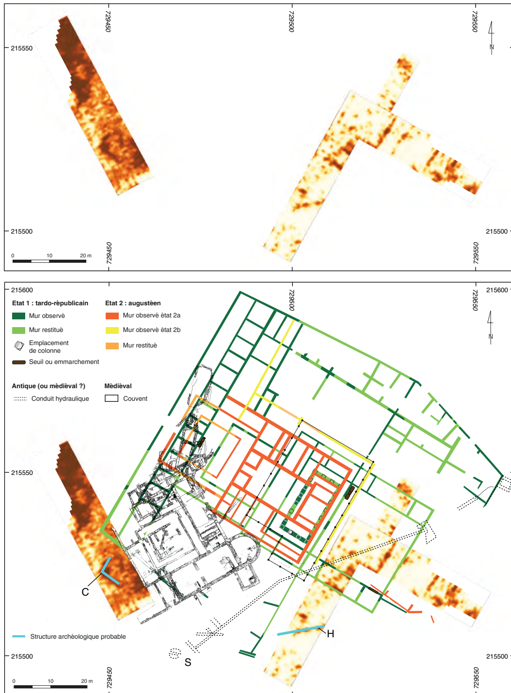
4. Bibracte, Mont Beuvray. Prospections géophysiques à la Pâturage du Couvent et au Champlain. La Pâturage du Couvent. Résultat des prospections au géoradar de 2013, avec constante de temps de 45 ns.
