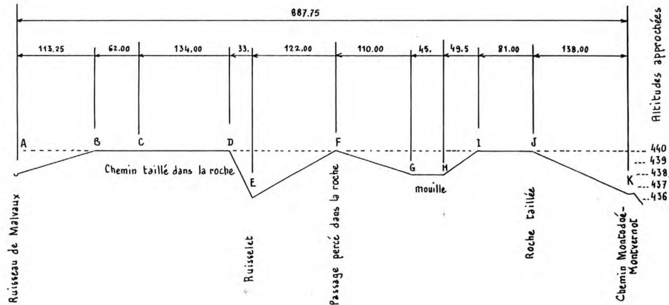
L'eau ainsi captée devait circuler dans une canalisation en bois en bordure est du chemin, supportée éventuellement par les banquettes taillées à flanc de roche. Les irrégularités minimales de niveau pouvaient être compensées par des calages. La très faible pente du parcours assure la régularité du débit et une chute plus puissante au point choisi.
