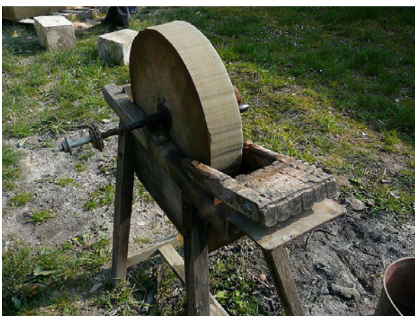
Fig.108 : Meule à émoudre à réservoir
