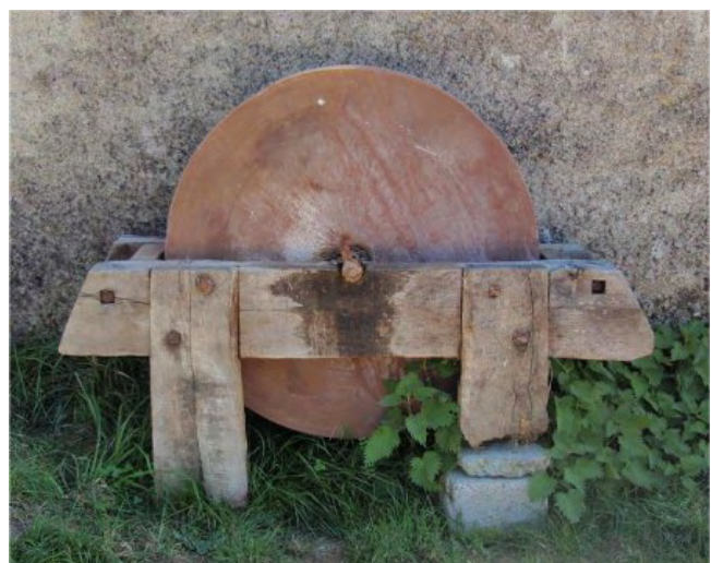
Fig.109 : Meule à émoudre sans réservoir d'eau
