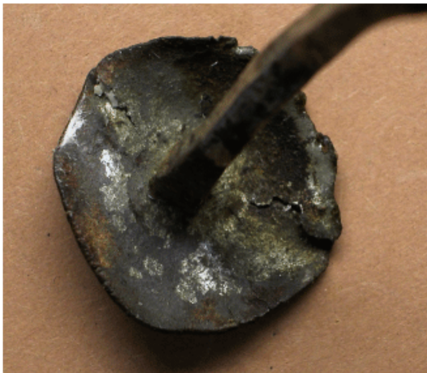
Fig. 12 : Présence de surfaces grises et brillantes sur les tiges et à l'intérieur des têtes des clous de fixation des étoiles. A noter la forme ondulée des tiges destinée à renforcer la fixation. D'autres pointes, plus rares, sont torsadées (clichés P. Maritiaux, LA3M).
