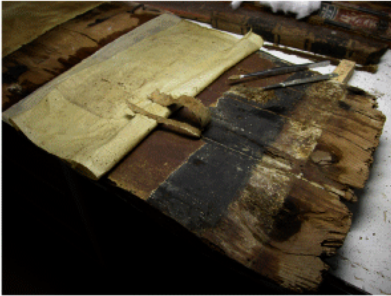
Fig. 38 : Elimination du badigeon brun sur la lame de plancher illustrée à droite. Exempte du repaint intermédiaire, la polychromie dégagée est complètement occultée par un dépôt dense de suie formant une couche opaque noire (cliché P. Maritiaux, LA3M).
