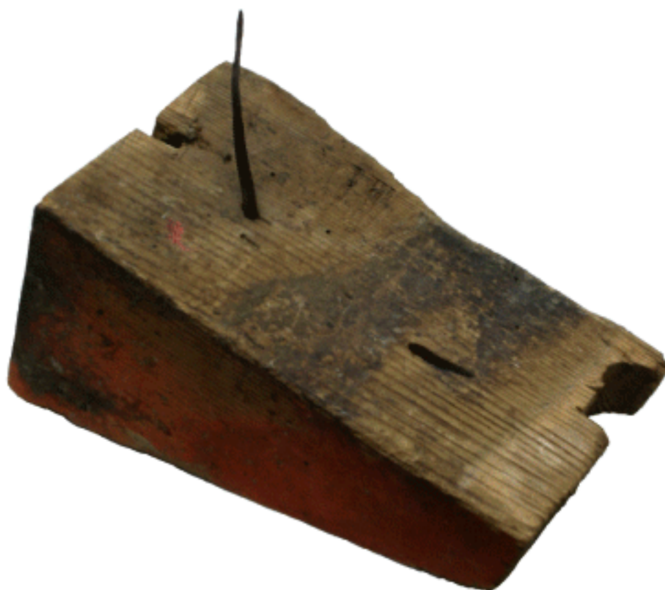
Fig. 23 : Un des coins utilisés pour la fixation des bandeaux sur les solives de rive (cliché P. Maritiaux, LA3M).
