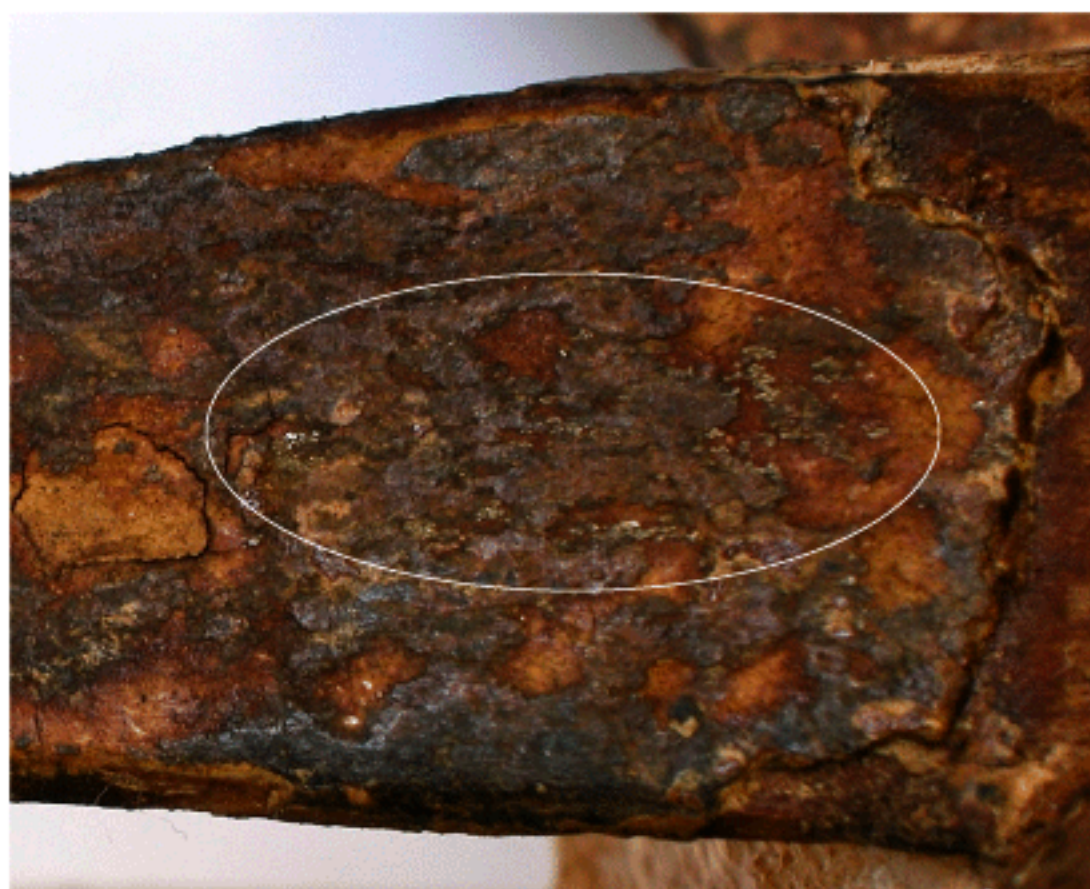
Fig. 11 : Points pailletés, à reflet métallique, disséminés à la surface de la couche grisâtre (cliché P. Maritiaux, LA3M).
