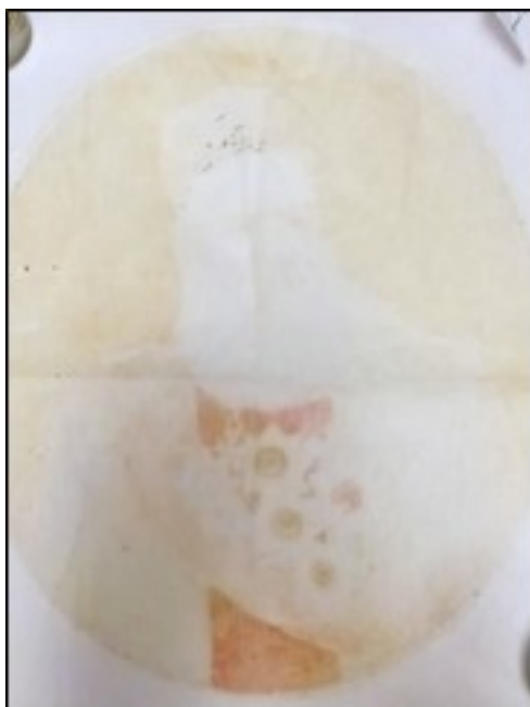
Fig. 1 : relargages sur une protection de surface. Le papier de protection a été appliqué à la Klucel® sur une peinture du XIXe siècle. Les relargages sont visibles sur la partie basse du papier.
