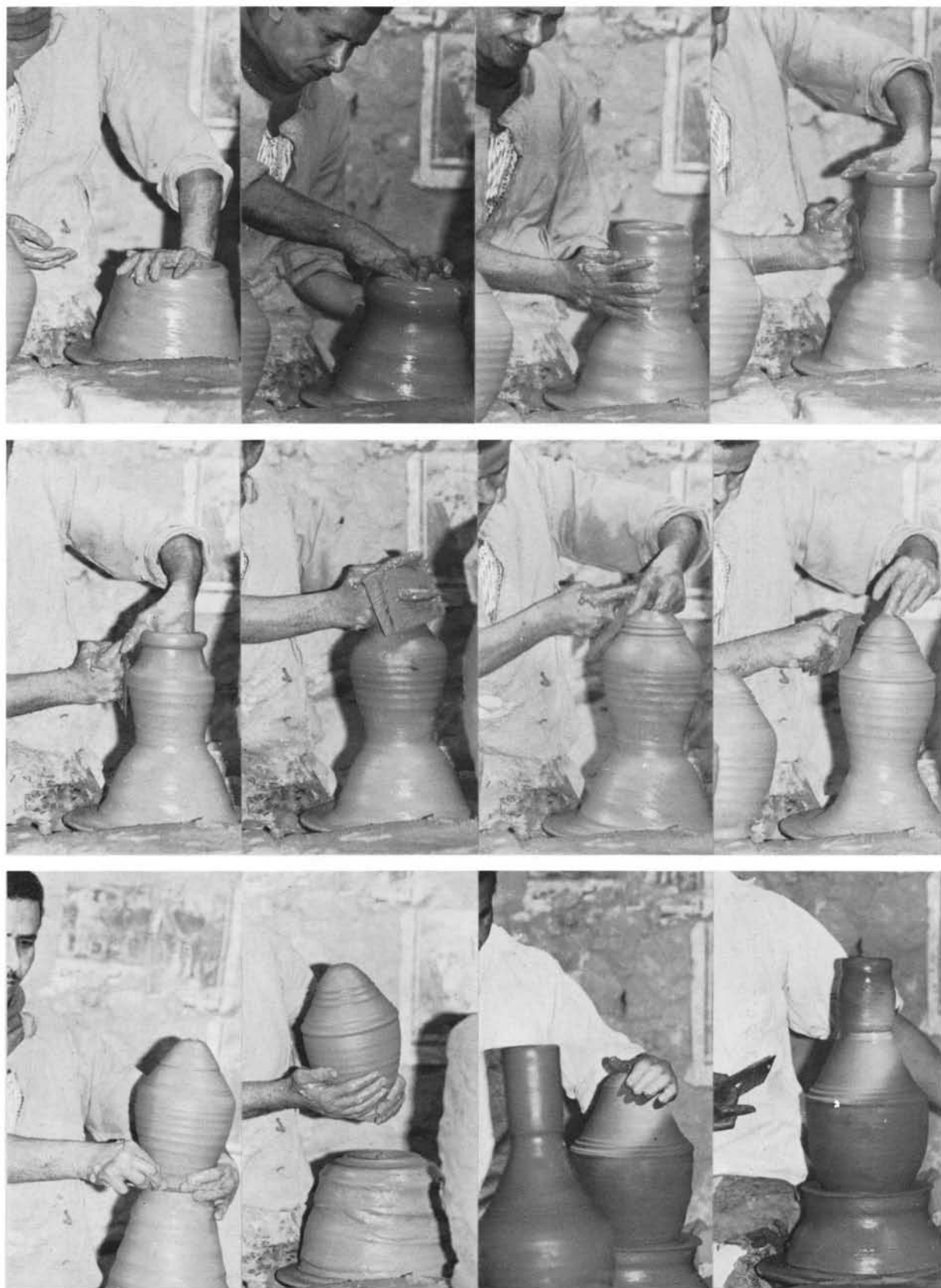
Phases de tournage (panses de gargoulettes et montage du col).
