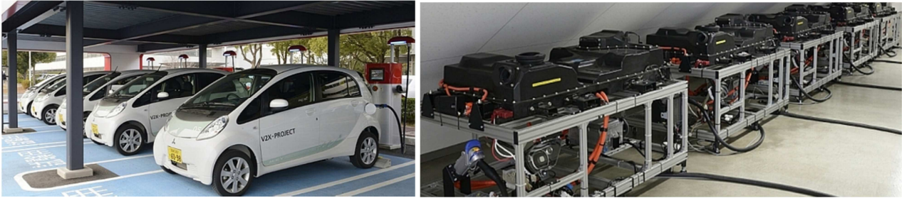
Figure 16 : Expérimentation de V2F à l'usine Mitsubishi Motors (Okazaki), parking des 5 I-Miev et combles avec batteries usagées
