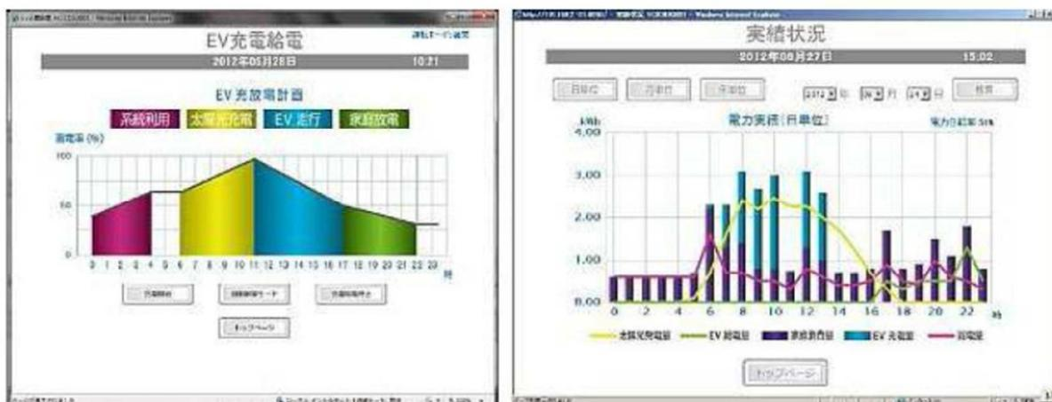
A gauche, exemple de plan d'utilisation de la batterie du véhicule électrique. En violet, recharge (partielle) sur le réseau, en jaune, recharge par les panneaux photovoltaïques, en bleu période d'usage du VE, en vert, décharge de la batterie au bénéfice du logement. A droite, exemple de résultats de la consommation/production sur la maison test.
