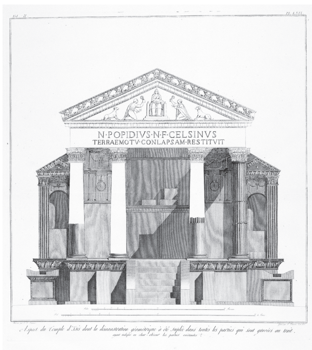
Fig. 2. Restitution du temple d'Isis de Pompéi par Piranèse (XVIII e siècle) : "Les parties indiquées en clair-obscur sont celles existantes. Les parties gravées au trait sont celles qu'on a supplées".
