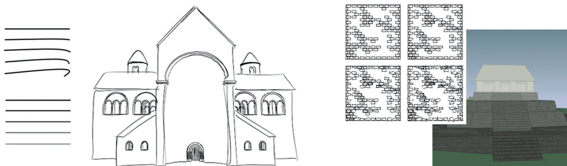
Fig. 3. Deux exemples de dispositifs visuels de l'incertitude de la représentation 3D : 3a. courbure et opacité des traits de contours (Strothotte) et 3b. schématisation de la texture (Potter).
