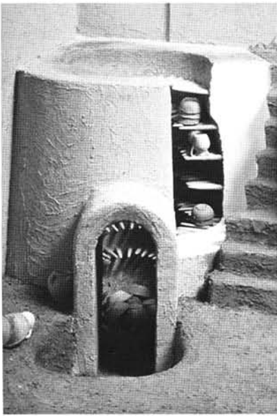
fig. 10: Marseille Sainte-Barbe. Restitution du four à barres, début XIII e s. Cl. CNRS-Durand.
