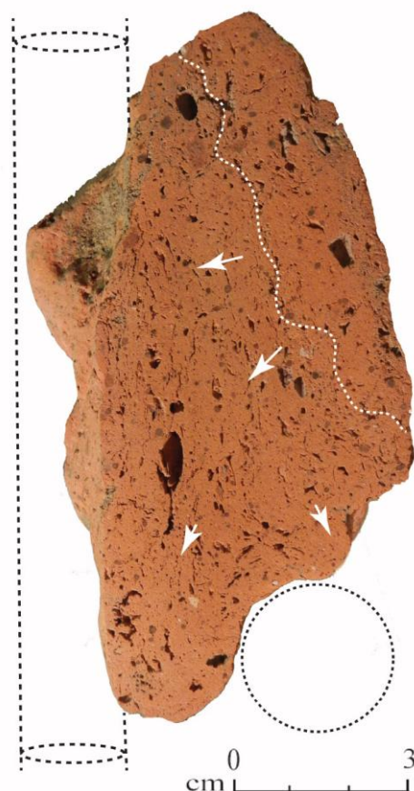
Fig. 20. Castello di Annone (AT), riorganizzazione e deformazione della porosità (vuoti residui di vegetali e vacuoli schiacciati) in base alla direzione del gesto esercitato durante la messa in opera e alla presenza di elementi lignei su cui l'impasto viene applicato (foto archivio SABAP-TO).
