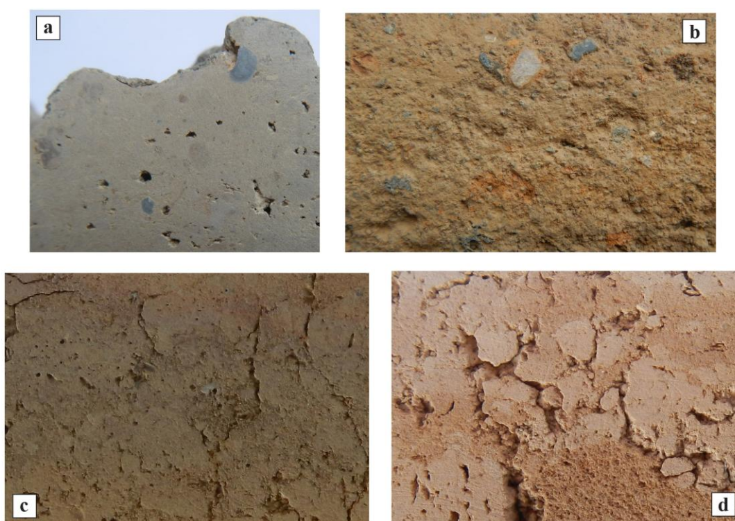
Fig. 10. Modalità di aggregazione: (a) Cesena-Foro Annonario (FC), impasto massivo senza aggregazione particolare (foto archivio SABAP-BO); (b) Mursia, Pantelleria (TP), scavi UNIBO, aggregati fortemente coalescenti, caratterizzati da limiti scarsamente netti e porosità inter-aggregato quasi assente; (c) Solarolo-via Ordieri (RA), scavi UNIBO, aggregati mediamente coalescenti, caratterizzati da limiti parzialmente netti e vuoti inter-aggregato variabilmente espressi e localizzati su alcuni bordi degli aggregati; (d) Solarolo-via Ordieri (RA), scavi UNIBO, aggregati e sacche di sedimento scarsamente coalescenti, con limiti netti e vuoti inter-aggregato spesso sviluppati sull'intero contorno degli aggregati.
