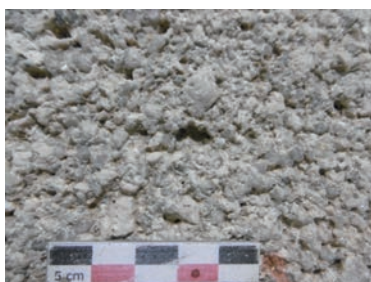
Grès et conglomérats, famille 1 Conglomérat à grands feldspaths blancs, de type « Grandvaux » B992.9.1315.124
