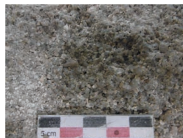
Grès et conglomérats, famille 1 Grès grossier à moyen à petits feldspaths blancs, de type « Tintry » B992.9.1411.248
