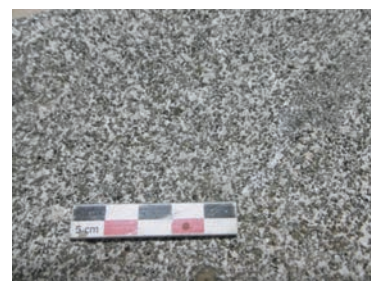
Vaugnerite, faciès V2 Vaugnerite à grain fin B987/5/1/109
