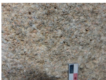
Grès et conglomérats, famille 2 Grès grossier à petits feldspaths et lithoclastes roses B988.5.5.157
