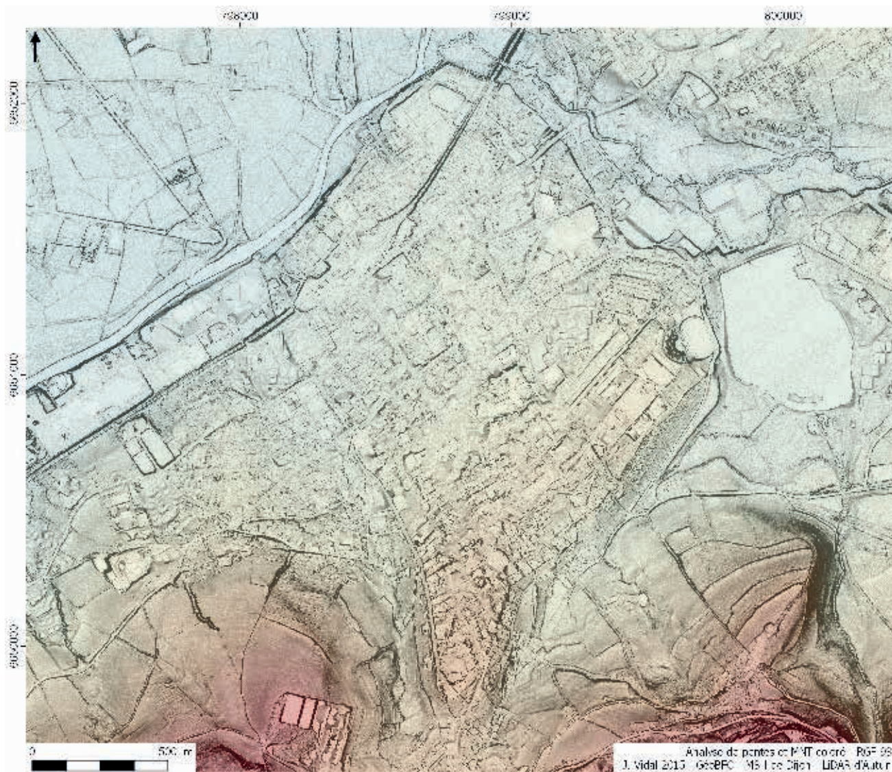
3. Restitution numérique de la topographie d'Autun issue des relevés LIDAR du printemps 2013 (relevés SINTEGRA ; © Maison des Sciences de l'Homme de Dijon / laboratoire TRACES / Ville d'Autun / Ministère de la Culture / Bibracte).
