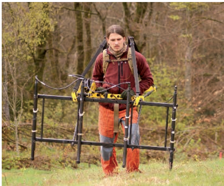
2. Bibracte, Mont Beuvray. Prospections géophysiques. Magnétomètre fluxgate Ferex (marque Foerster).
