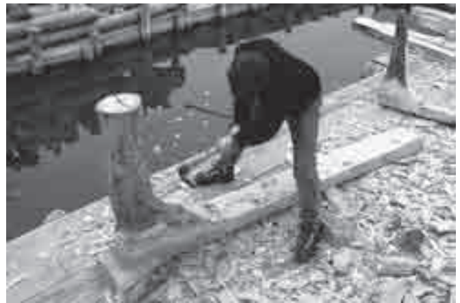
Fig. 10. Façonnage intensif du coude d'une courbe (photo Yves André).
