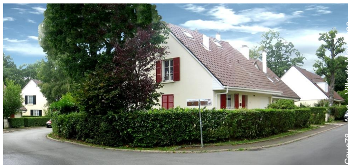
Isoler et colorer : Les maisons du Bois de Maurepas. Un isolant revêtu d'un bardage de clins de bois, peint ou lasuré.
