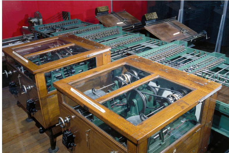
Fig. 5. Partie de l'analyseur différentiel exposée au Science Museum London.
