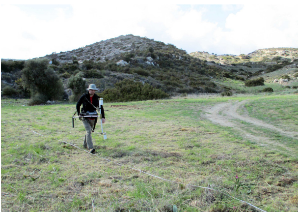
Fig. 3 – Prospection magnétique avec un gradiomètre au césium G-858 (Geometrics; cliché J.-D. Vigne).
