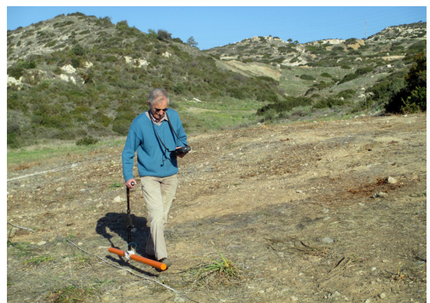
Fig. 4 – Prospection électromagnétique avec un CMD Mini-Explorer (Gf Instruments; cliché J.-D. Vigne).
