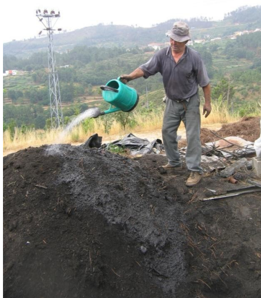
Fig. 10. Depois de fechada a porta do forno, Sezignano Ramalho rega com água a terra que cobre a louça. Bisalhães. Fotografia: A. Durand, 20 de Junho de 2007
