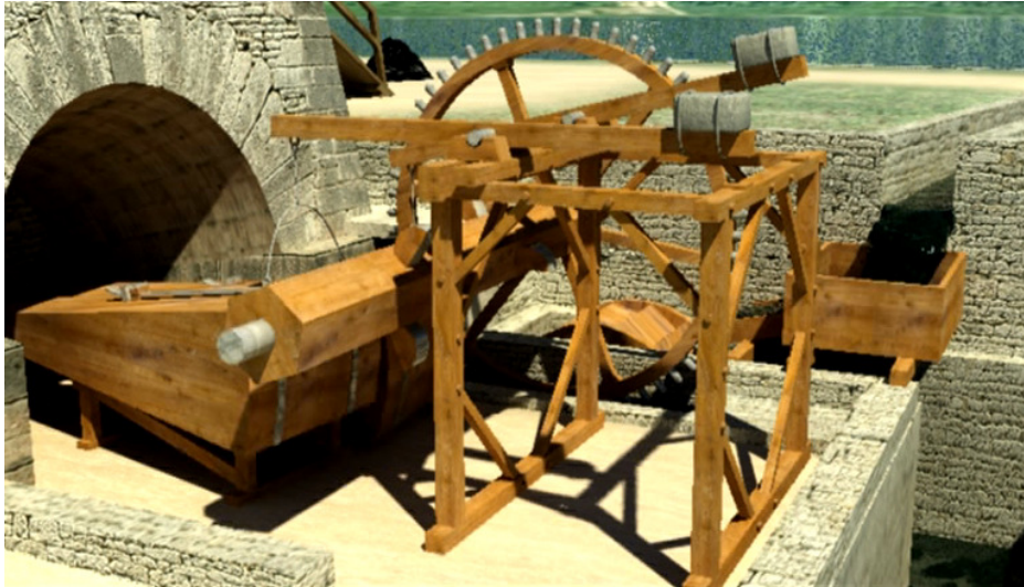
Vue 3D de la soufflerie avec sa roue hydraulique
