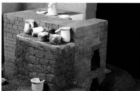
Fig.18 : Maquette du four 110 : Proposition de reconstitution d'après Agricola (cliché Ph. Foliot, C.C.J.-C.N.R.S.).
