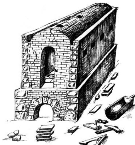
Fig.2 : Four à cuire le biscuit (Piccolpasso, Conti 1976).
