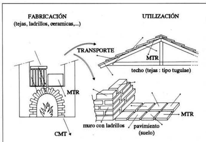
Fig. 10. Les matériaux de construction peuvent être cuits à plat, debout ou de chant dans le four (l'indication MTR correspond à l'aimantation thermorémnente). Ils sont employés dans des positions indifférentes dans les constructions (Amigues 1994: 804, fig. 6).
