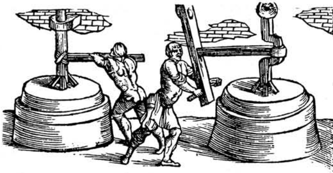
Fig. 24: Deux modèles de moulins à bras pour les minerais métalliques dont un à bielle-manivelle, XVIe s. (Biringuccio1977: 142 r).
