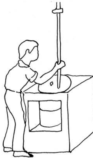
Fig. 21: Moulin à vernis en auge à barre excentrique, tournant dans un caisson à Saint-Jean-de-Fos, XXe s. (Vayssettes 1987: 138 d'après Paul Lanave).
