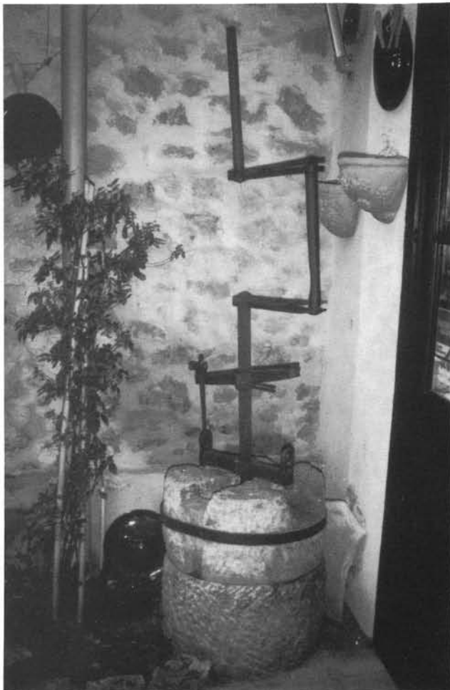
Fig. 31: Moulin à bras à vernis, composé d'une dormante en granite encaissée normalement dans un demi-tonneau et d'une tourante faite de deux portions de demi-meules assemblées de façon non-jointive par des pièces métalliques, Poterie Foucard-Jourdan à Vallauris, XIXe-XXe s. Cliché H. A.
