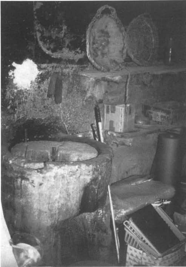
Fig. 14: Moulin manuel à vernis en auge et à meule partielle des frères Goriz à Teruel, début XXe s. Cliché J.T.
