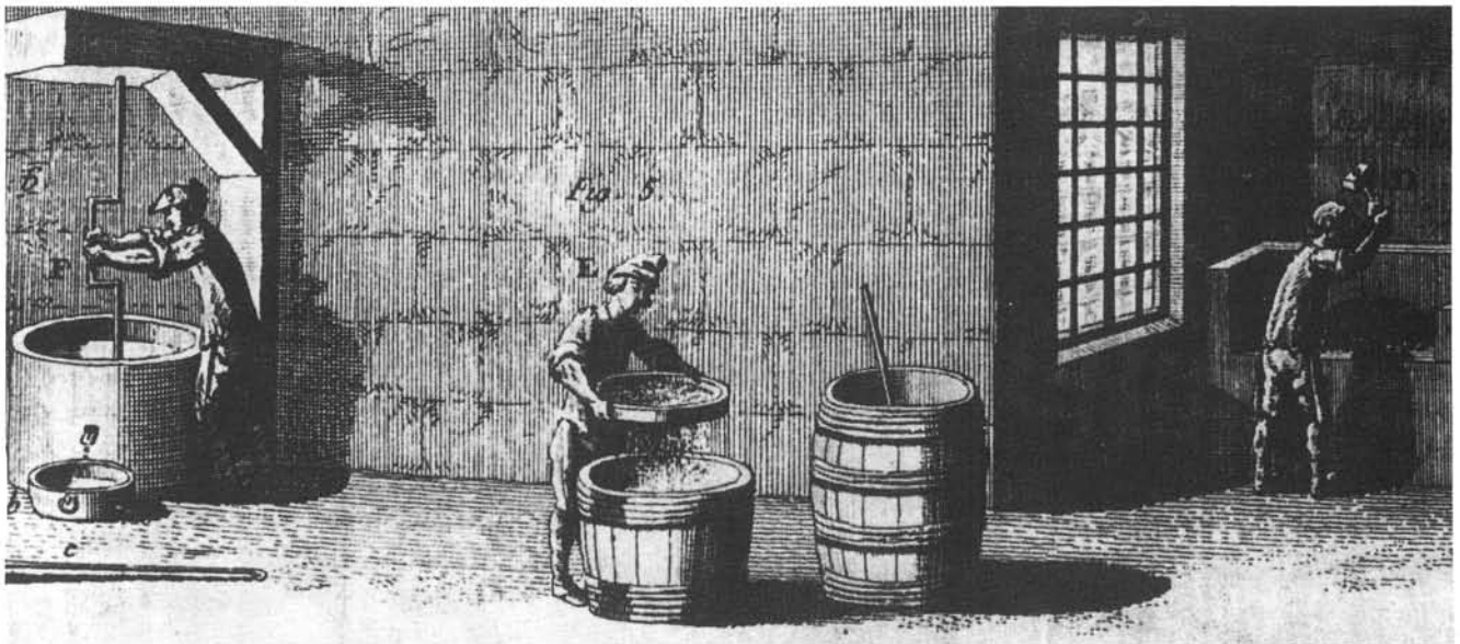
Fig. 2: Préparation du vernis. D: concassage, E: mouture, F: tamisage. (Duhamel du Monceau 1773).
