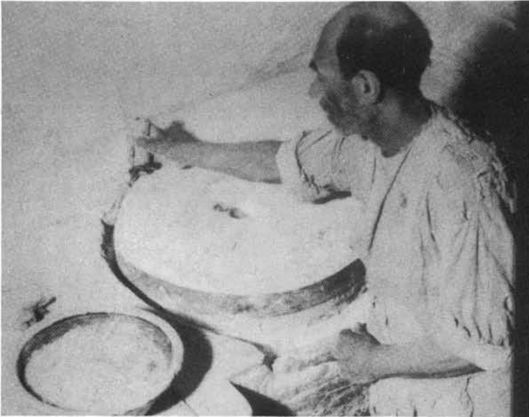
Fig. 49: Travail des produits de la glaçure en Iran. Première étape: mouture en voie sèche. (Wulf 1966: 151).
