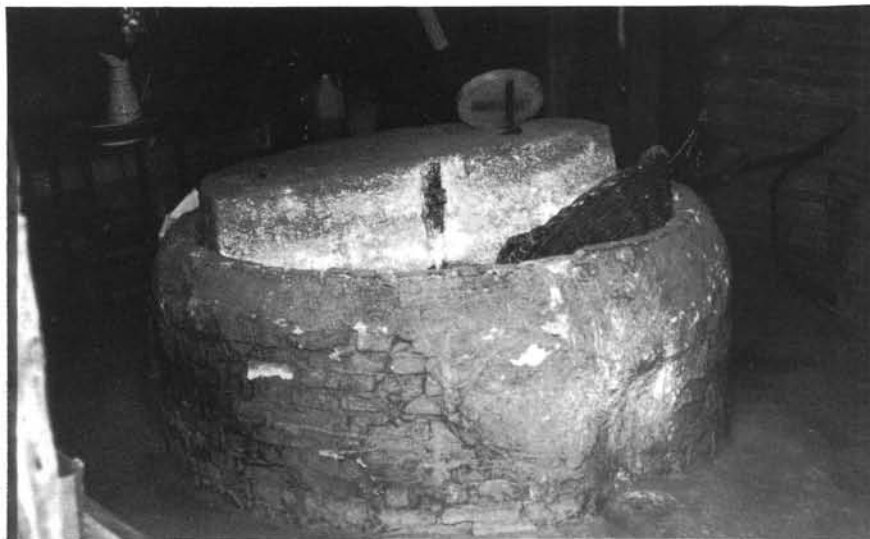
Fig. 35: Grand moulin à vernis des frères Goriz à Teruel. A traction animale directe, composé d'une auge et d'une demi-meule comportant un rainurage partiel sur sa face inférieure facilitant l'engrainement des matériaux. Cliché J. T.
