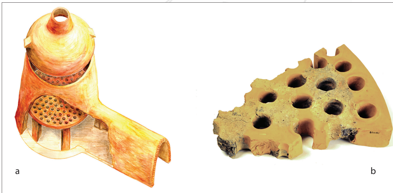
Fig. 6. Fours de potier bâtis en élévation : a. Reconstitution graphique (dessin M. Giaretti) ; b. Grille restaurée.
