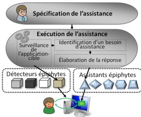
**Figure 1 : Processus d'adjonction d'un système d'assistance épiphyte**
