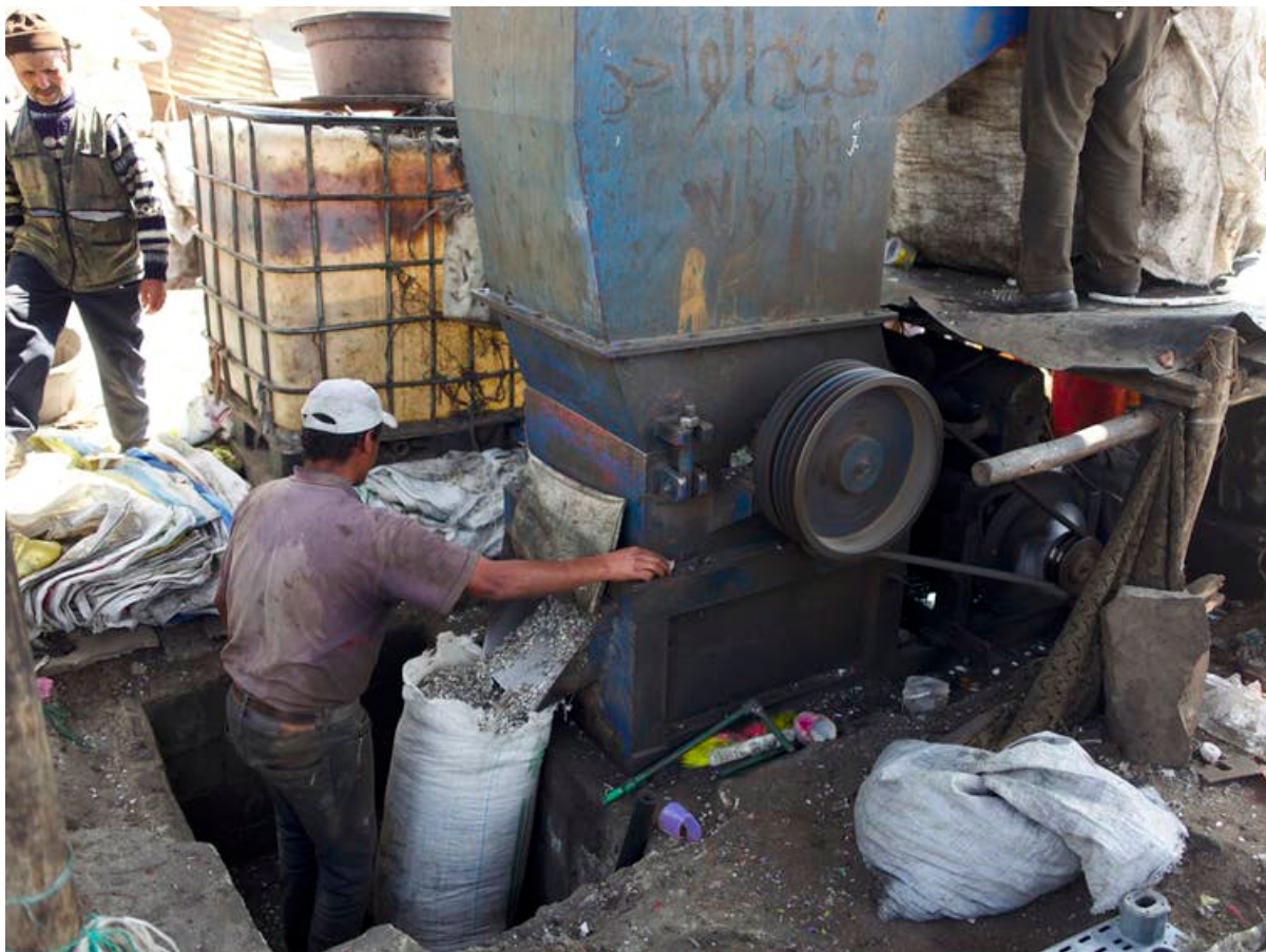
Il n'y a pas d'électricité dans les gelssas et cette machine est alimentée par un groupe électrogène. Photo Pascal Garret, avril 2017.
