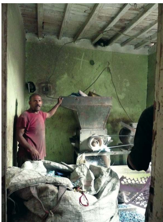
Figure 8 : Une broyeuse de plastique à Batn el Baqara, Le Caire
