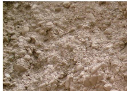
**Photo 1: Argiles altérés dans l'horizon supérieur au contact discordant avec la couche de conglomérat**
