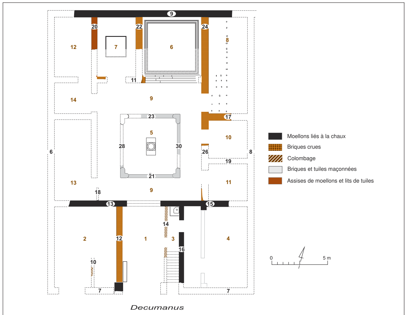
Figure 267 - Place Formigé. Plan de la domus à l'atrium fleuri indiquant les différentes techniques de construction utilisées pour les murs (dao S. Saulnier).
